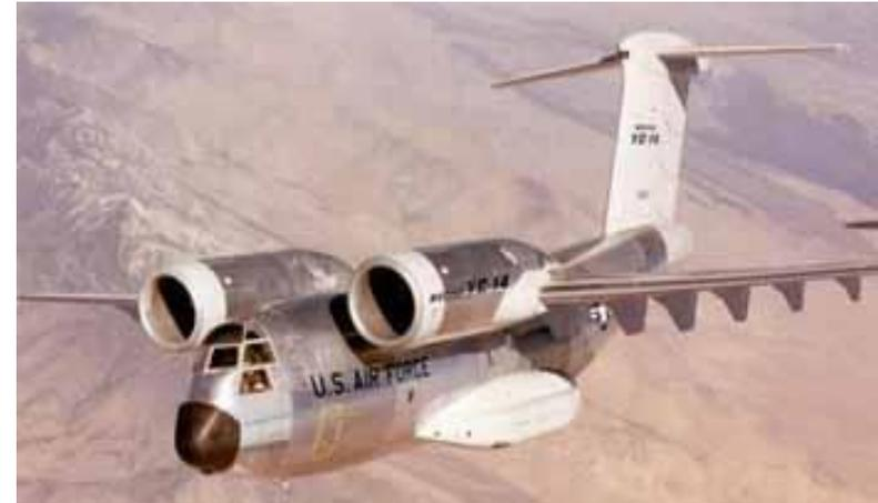
Инициатором работ над самолетом использующим нетрадиционный метод повышения подъемной силы, был авиаконструктор Антонов О.К. Он говорил «..могучий поток газов, с большой скоростью вытекающий из сопла реактивного двигателя, пройдет над крылом, создавая дополнительную подъемную силу».
